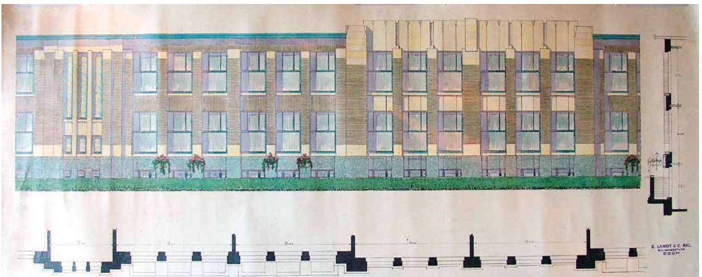
Ontwerptekening van de gevel aan de Beukenlaan, waarop Bal en Lamot met kleuren en schaduw het geometrische gevelspel nadrukken. Ook het belang van de voortuin wordt in deze ontwerptekening benadrukt door het talud met een groene strook aan te geven (© Vlaams Architectuurinstituut)
